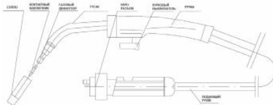
Горелка служит для подведения к месту сварки проволоки, газа и напряжения. Подключается к аппарату с помощью специального евро разъема (*WMA 205 MQ*, *WMA 225 MQ*) или используется жесткое соединение (*WMA 175M*).
