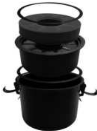
Рис. 21 Установка воздушного фильтра в стакан воздухоочистителя
