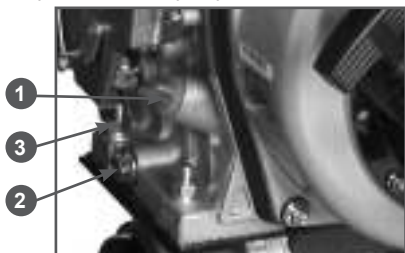
Рис. 10 Проверка уровня масла в картере
