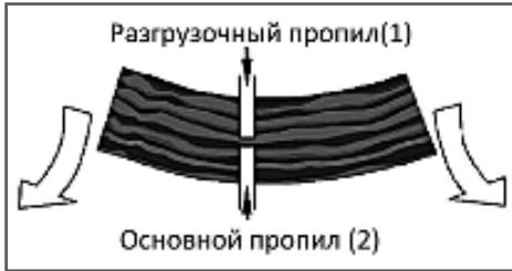
Рис. 18 Распиливание дерева, когда его нижняя часть находится под напряжением
