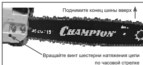
Рис. 5 Регулировка натяжения цепи
