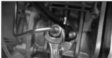
Рис. 12 Удаление воздуха из топливного насоса
