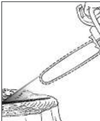
Рис. 7 Проверка смазки шины и цепи
