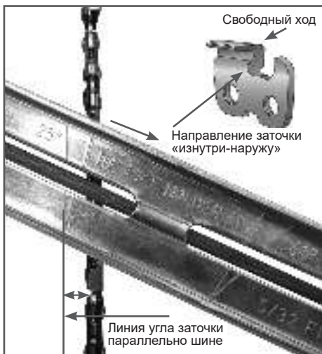
Рис. 16 Определение угла заточки
