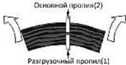
Рис. 10 Распиливание дерева, когда его верхняя часть находится под напряжением
