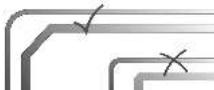
Рисунок 9 – Все изгибы должны иметь плавный переход
