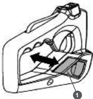
Рис. 8 Фиксатор поворота задней рукоятки 1. Фиксатор
