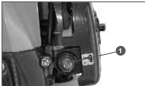
Рис. 3 Расположение ручного топливного насоса
