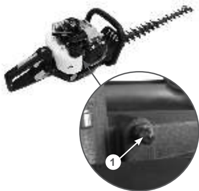
Рис. 16 Расположение пресс-маслёнки 1. Пресс-маслёнка
