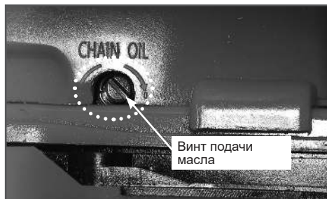
Рис. 11 Расположение регулировочного винта подачи масла
