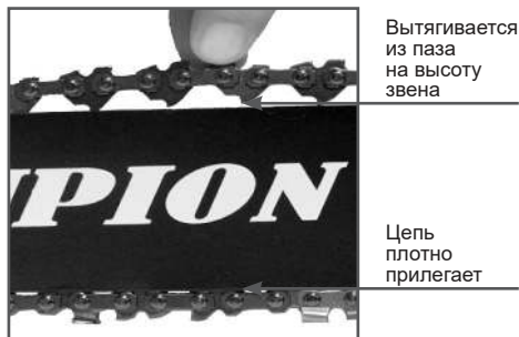
Рис. 5 Регулировка натяжения цепи
