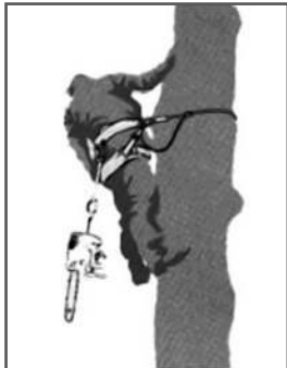
Рис. 20 Крепление бензопилы к задней средней точке ремня
