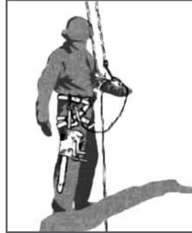
Рис. 19 Пример крепления пилы к ремню оператора
