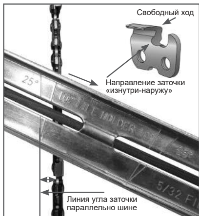
Рис. 29 Определение угла заточки
