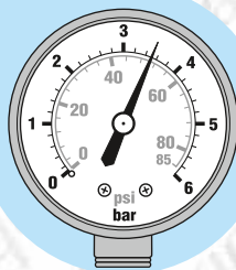
рис. 10. После того, как давление, достигнет определенного (настроенного) значения (давление отключения), реле остановит насос.
