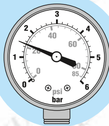
рис. 12. Как только давление в системе понизится до определённого (настроенного) значения (давление включения), реле включает насос, и цикл повторяется.
