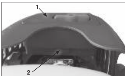
Рис. 16 Снятие крышки воздушного фильтра ТА3,5
