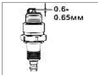
Рис. 19 Проверка свечи зажигания
