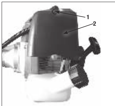
Рис. 14 Снятие крышки воздушного фильтра ТА2
