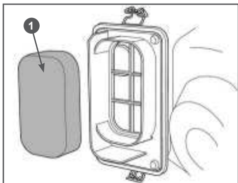
Рис. 16 Обслуживание воздушного фильтра
