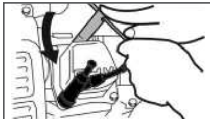
Рис. 20 Обслуживание свечи зажигания
