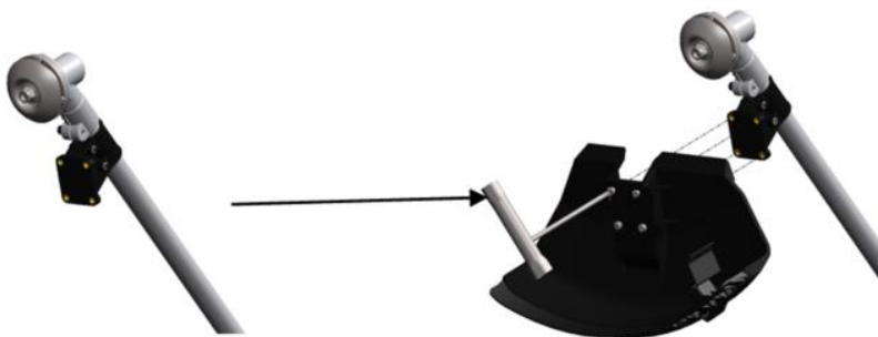
Рис. 6. Схема установки защитного кожуха.
