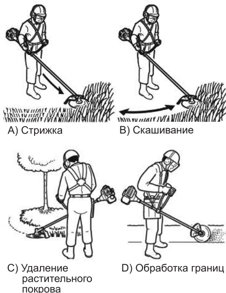
Рис. 15 Виды работ триммером
