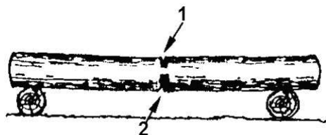
Рис. 10. Пропилы при раскряжевке дерева на двух опорах
