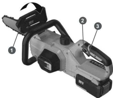
Рис. 5. Расположение органов управления на задней рукоятке
