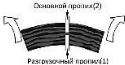
Рис. 11 Распиливание дерева, когда его верхняя часть находится под напряжением
