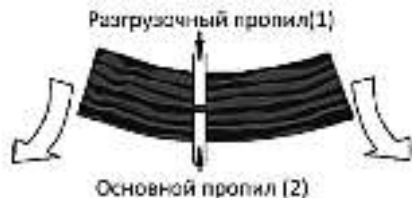
Рис. 12 Распиливание дерева, когда его нижняя часть находится под напряжением
