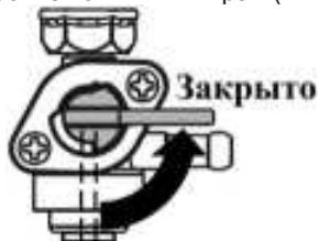
Рис. 7 Топливный кран закрыт
