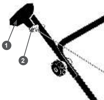
Рис. 7 Крепление ручки стартера на рукоятке
