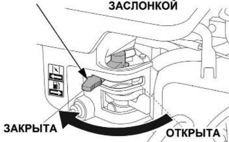
Рис. 18. Рычаг управления воздушной заслонкой
