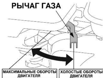
Рис. 20. Положения рычага газа
