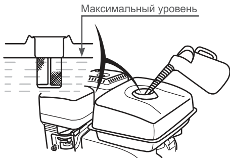
Рис. 9. Максимальный уровень топлива в топливном баке
