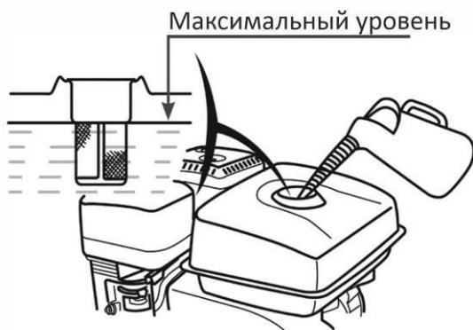
Рис. 5. Определение максимального уровня топлива в баке.
