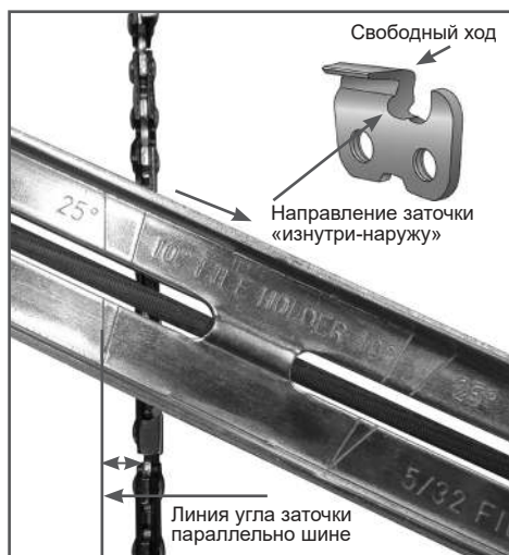
Рис. 22 Расположение линии угла заточки
