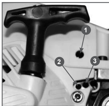
Рис. 20 Винты регулировки карбюратора
