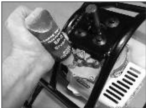
Рис. 15 Добавление смазки в корпус редуктора
