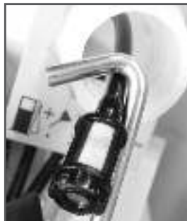
Рис. 12 Извлечение топливного фильтра
