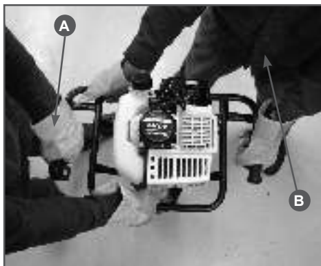
Рис.10 Положение рук при работе вдвоем
