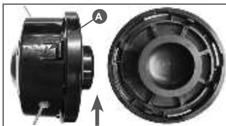
Рис.13 Снятие крышки триммерной головки
