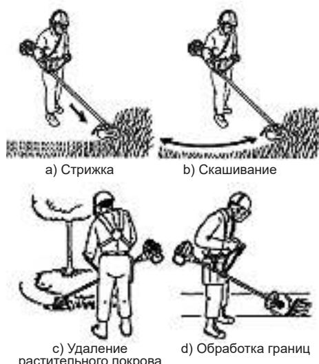
Рис. 11 Движение триммера
