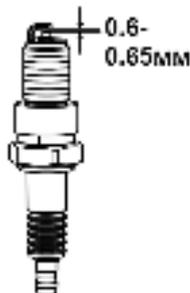
Рис.17 Свеча зажигания
