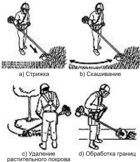
Рис. 11 Движение триммера
