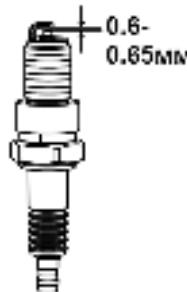
Рис.17 Свеча зажигания
