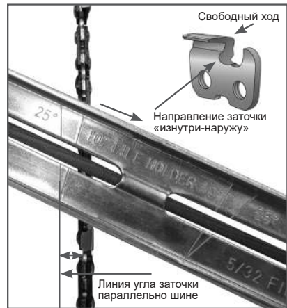
Рис. 19 Определение угла заточки
