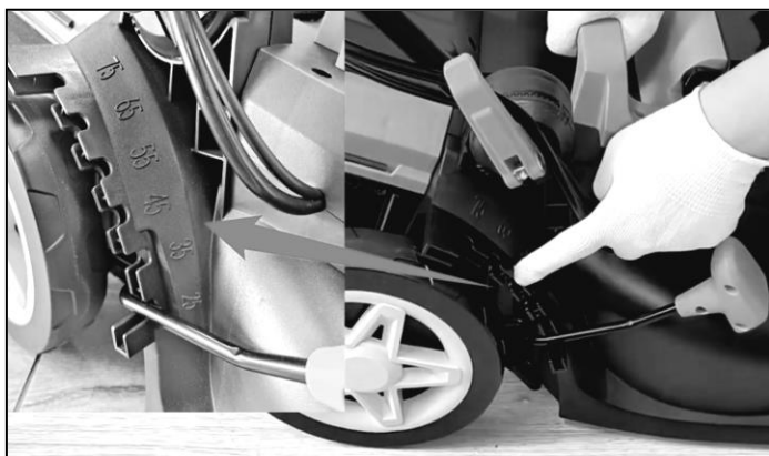
Рис. 7 Механизм регулирования высоты кошения у модели ELM2400
