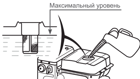
Рис. 28 Максимальный уровень топлива в топливном баке
