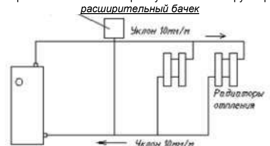
Рис.1. Схема монтажа открытой системы отопления
