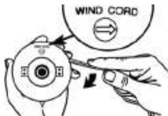
Рис. 13. Намотка корда на катушку
