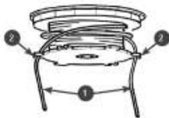
Рис. 14. Фиксация концов корда 1. Концы корда 2. Пазы на катушке
