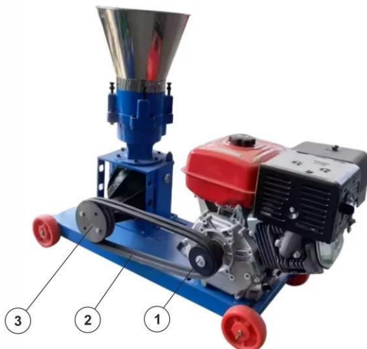
Рис. 2.2. Схема гранулятора с бензиновым двигателем.
