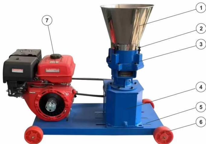
Рис. 2.1. Схема гранулятора с бензиновым двигателем.
