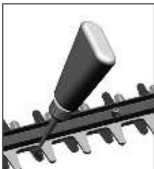
Рис. 3 Смазка режущих ножей
