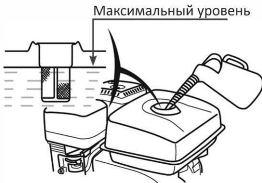
Рис. 8. Определение максимального уровня топлива в баке.
