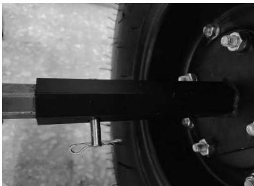
Рис. 3. Установка колеса в сборе на выходной вал редуктора
