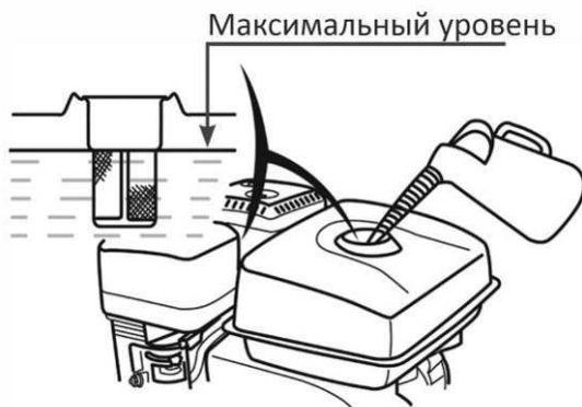
Рис. 5. Определение максимального уровня топлива в баке.
