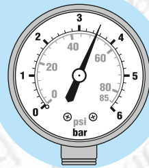
рис. 10. После того, как давление, достигнет определенного (настроенного) значения (давление отключения), реле остановит насос.
