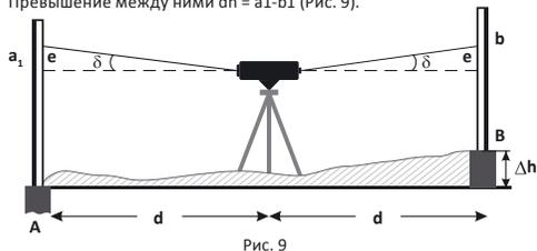
в) Переместите нивелир и установите его на расстоянии 1-2 м от рейки А (Рис. 10). Отгоризонтируйте прибор и возьмите отсчеты  $a_2$  и  $b_2$  по рейкам А и В соответственно. Если  $|(a_2 - b_2) - (a_1 - b_1)| < 3$  мм, дальнейшая юстировка не требуется.
