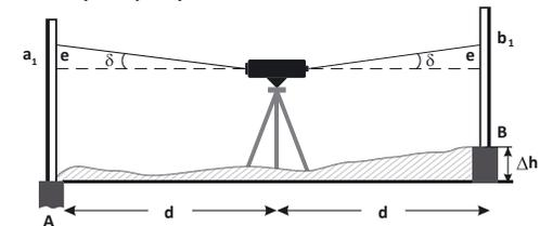
3) Przesunąć niwelator i ustawić w odległości 1 - 2 m przed punktem A. Ponownie odczytać z łatki wysokość punktu A (np. a2 = 1,461 m). Dodać różnicę z poprzedniego pomiaru do a2. 1,461 + 1,553 = 3,014 m.
