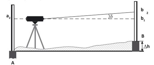
4) Z laty odczytać ponownie wysokość punktu B (b2). Porównać wcześniej obliczoną wartość (np. 3,014 m) z b2. Jeżeli oś celowa niwelatora jest w poziomie, to obie wartości będą jednakowe. Jeżeli różnica jest większa niż 3 mm, to należy ustawić łąkę pomiarową jeszcze raz na punkcie i kręcić śrubami nastawczymi krzyża nitek, aż do osiągnięcia przez krzyż nitek obliczonej wartości (np. 3,014 m). Jeżeli brak jest doświadczenia w kalibracji urządzenia, to zaleca się oddanie instrumentu do serwisu.
