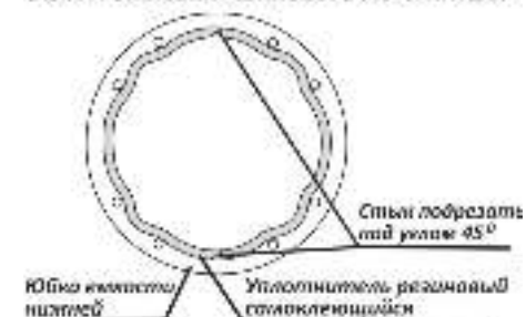
СХЕМА УСТАНОВКИ РЕЗИНОВОГО УПЛОТНИТЕЛЯ
