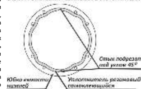
СХЕМА УСТАНОВКИ РЕЗИНОВОГО УПЛОТНИТЕЛЯ
