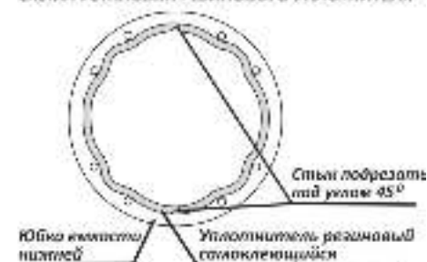
СХЕМА УСТАНОВКИ РЕЗИНОВОГО УПЛОТНИТЕЛЯ
