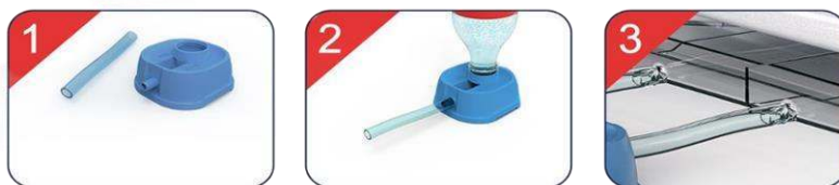
Рис. 9. Схема подключения системы автодолива
