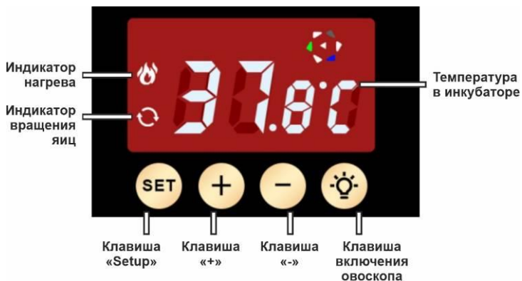
Рис. 8. Панель управления режимами инкубации.
