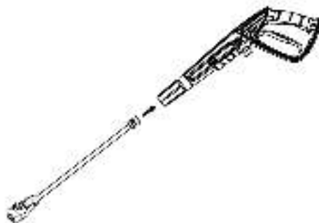
Рис. 3 Установка головки и струйной трубки
