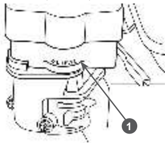
Рис. 28 Уровень масла в масляной ванне воздушного фильтра
