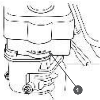
Рис. 12 Уровень масла в масляной ванне воздушного фильтра
