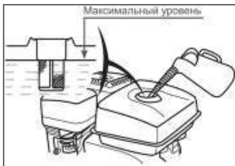
Рис. 12 Максимальный уровень топлива в топливном баке
