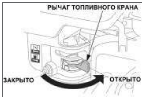
Рис. 13 Рычаг топливного крана
