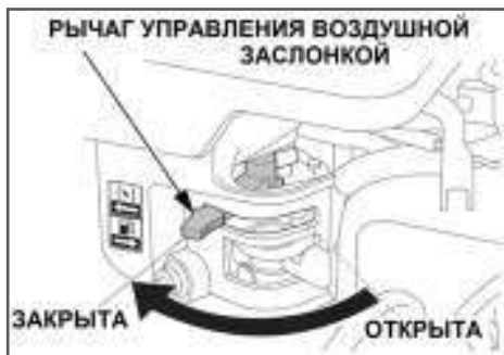
Рис. 14 Рычаг управления воздушной заслонкой (вид сверху)
