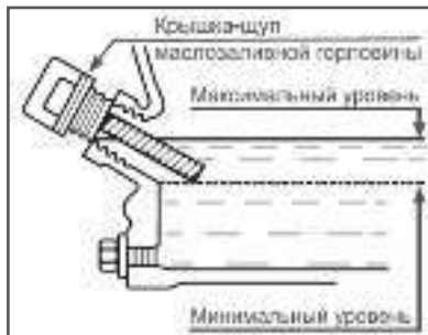
Рис. 11 Проверка уровня масла в картере
