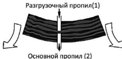
Рис. 25. Распиливание дерева, когда его нижняя часть находится под напряжением
