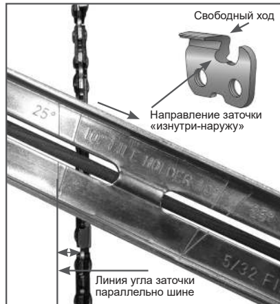
Рис. 37. Определение угла заточки
