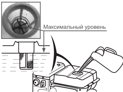
Рис. 8 Максимальный уровень топлива в топливном баке
