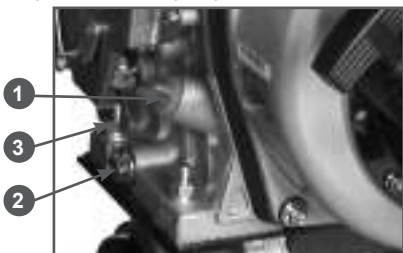
Рис. 10 Проверка уровня масла в картере
