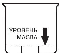
Рис. 23 Уровень масла в масляной ванне воздушного фильтра
