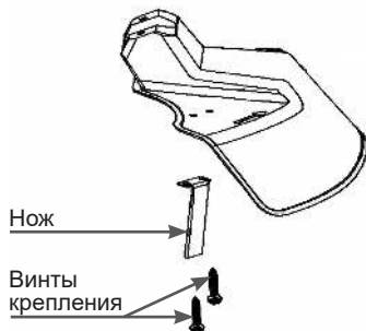
Рис. 2 Установка ножа для обрезки корда
