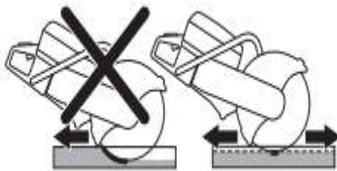
Медленно перемещайте лезвие вперед и назад, чтобы обеспечить небольшую площадь контакта между лезвием и разрезаемым материалом. Это снижает температуру лезвия и обеспечивает эффективную резку
