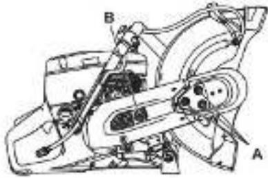
Ослабьте три гайки (А), удерживающие верхний защитный кожух ремня. Поверните натяжитель ремня (В) в положение "О", чтобы ослабить натяжение.
