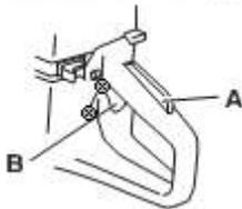
Блокировка пуска остается нажатой до тех пор, пока нажата дроссельная заслонка. При отпуске рукоятки спусковой крючок дроссельной заслонки и фиксатор спускового крючка дроссельной заслонки возвращаются в исходное положение. Это контролируется двумя независимыми системами возвратных пружин. Это означает, что триггер дроссельной заслонки автоматически блокируется в положении холостого хода.
