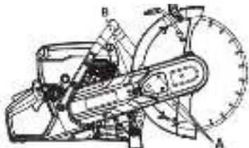
Снимите верхний защитный кожух ремня. Теперь снимите защитный кожух заднего ремня безопасности.
