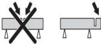
Защемление или заклинивание Тщательно оцените, как объект будет двигаться на заключительном этапе резки, чтобы избежать защемления или заклинивания. Разрез должен открыться во время разреза. Если предмет провисает и разрез начинает закрываться, лезвие может защемироваться, что может привести к отдаче или повреждению лезвия.
