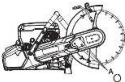
Поверните защитный кожух лезвия (Е) вверх и вниз 3-5 раз, а затем затяните гайки (А) комбинированным гаечным ключом.
