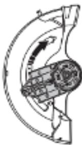
Поверните корпус подшипника в противоположном направлении и снова установите упор.
