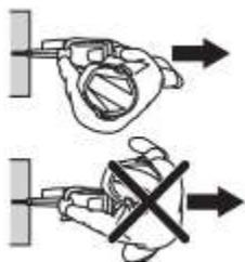
При работающем двигателе соблюдайте безопасное расстояние от режущего лезвия. Никогда не оставляйте машину без присмотра при работающем двигателе. Никогда не перемещайте резчик, когда режущее оборудование вращается. Убедитесь, что лезвие полностью остановилось, прежде чем ставить машину на землю. Машина оснащена замедлителем трения для сокращения времени остановки лезвия. Защитный кожух режущего обо-
