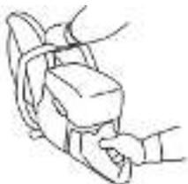
Встаньте параллельно режущему лезвию. Избегайте стоять прямо позади. В случае отдачи резчик будет двигаться в плоскости режущего полотна.
