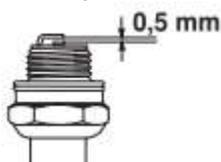
**ОБРАТИТЕ ВНИМАНИЕ!** Всегда используйте рекомендованный тип свечей зажигания! Использование неправильной свечи зажигания может привести к повреждению поршня/цилиндра.
