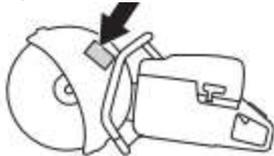
Убедитесь, что втулка на валу шпинделя станка соответствует центральному отверстию режущего лезвия. На лезвиях нанесен диаметр центрального отверстия.
