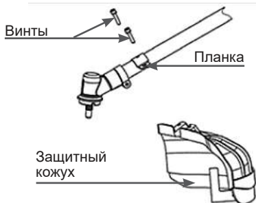
Рис. 3 Установка защитного кожуха
