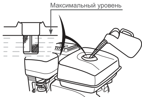
Рис. 6. Максимальный уровень топлива в топливном баке
