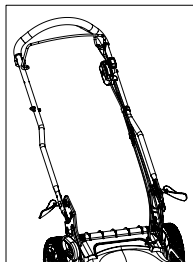
Рис. 4. Установка рабочей рукоятки в рабочее положение
