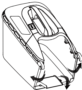
Рис.6. Крепление нижней части травосборника
