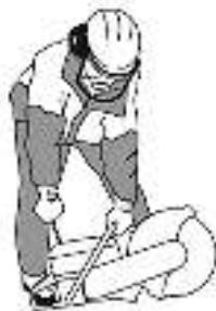
Рис. 7 Положение оператора при запуске двигателя
