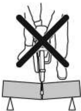
Рис. 14 Отдача при защемлении диска
