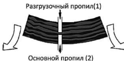
Рис. 12 Распиливание дерева, когда его нижняя часть находится под напряжением
