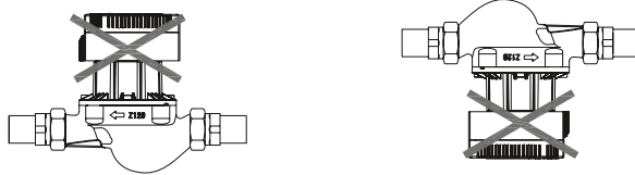
Рис.4 Недопустимое расположение вала насоса
