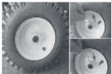
Установка шплинта на левом колесе
